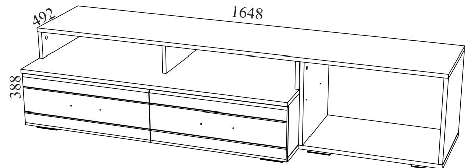
Габаритные размеры: ширина - 1648 мм, высота - 388 мм, глубина - 492 мм.
