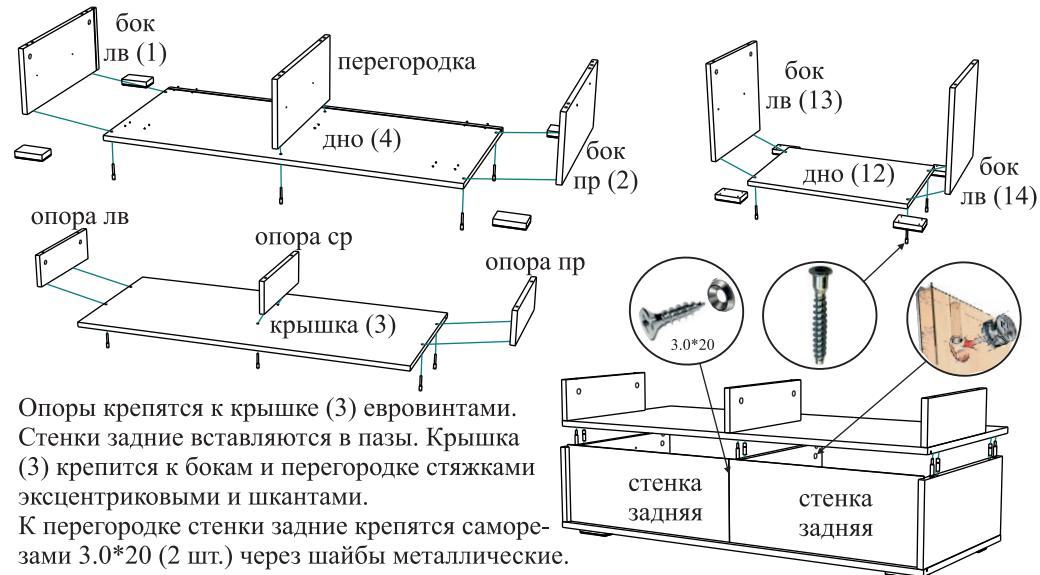
Опоры крепятся к крышке (3) евровинтами. Стенки задние вставляются в пазы. Крышка (3) крепится к бокам и перегородке стяжками эксцентриковыми и шкантами.
