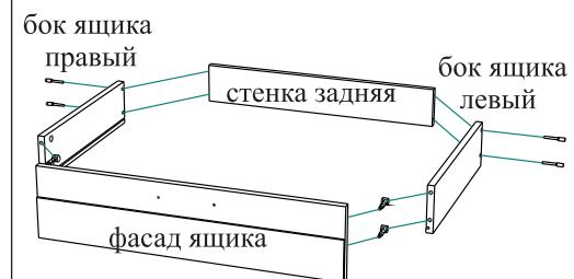
Бока ящика крепятся к стенке задней ящика евровинтами, фасад ящика (с зеркалом 41) - к бокам ящика стяжками эксцентриковыми.
