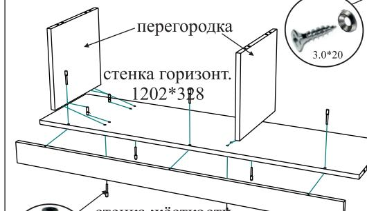
Перегородки крепятся к стенке горизонтальной 1202\*328 евровинтами и шкантами, стенка жёсткости - евровинтами.
