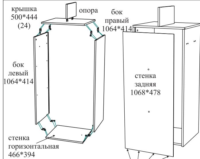
Стенка горизонтальная 466\*394 крепится к бокам 1064\*414 стяжками эксцентриковыми и шкантами. Опора крепится к крышке 500\*414 (24) евровинтами и шкантами, крышка к бокам - стяжками эксцентриковыми и шкантами. Стенка задняя 1068\*478 вставляется в пазы и крепится к стенке горизонтальной 466\*394 саморезами 3,0\*20 через шайбы металлические с шагом, примерно, 130 мм.
