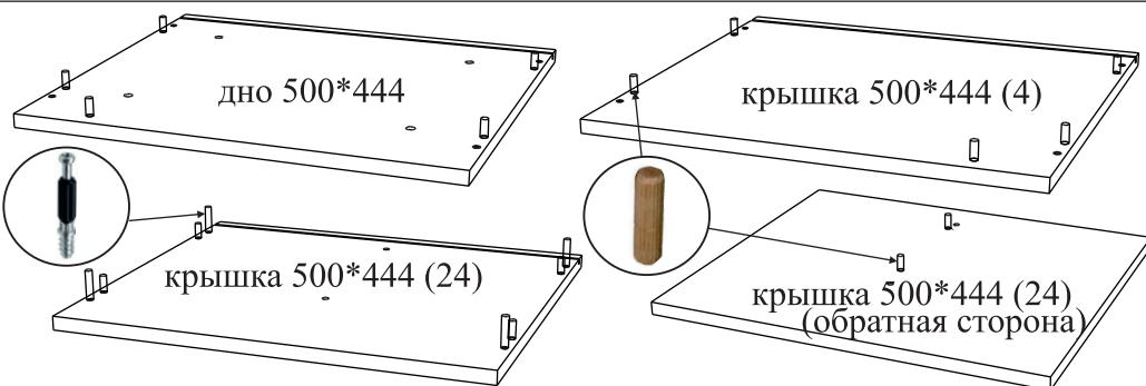
На крышки (500\*444) и крышку (1452\*328, дно (500\*444), дно (1700\*540) и стенку горизонтальную 1202\*328 устанавливаются шканты, на фасады ящиков - штоки эксцентриков.
